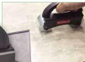
Enclencher le clipsage en tapant une fois, puis rouler.
