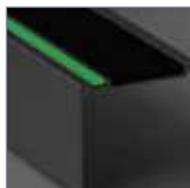
Résultat test lumineuse si exposition à 150 lux pendant 15 minutes.
