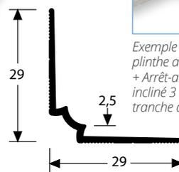
Exemple de réalisation de plinthe avec une chute de LVT + Arrêt-angle 2,5 mm + Arrêt-incliné 3 mm pour cacher la tranche de la plinthe.
