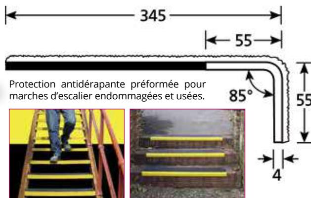
Protection antidérapante préformée pour marches d'escalier endommagées et usées.
