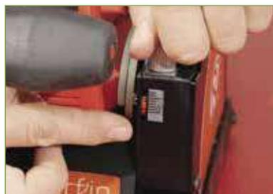
Réglage de la profondeur avec index
