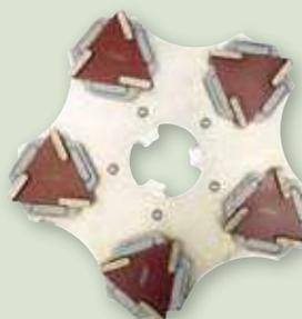
**S'installe uniquement sur une monobrosse Sandy 2 de 2200 W**, seule machine possédant des engrenages capables de résister à la force de traction démultipliée et à son poids. Le système d'accroche quart de tour permet de changer rapidement le plateau. Poids : 14,5 kg
