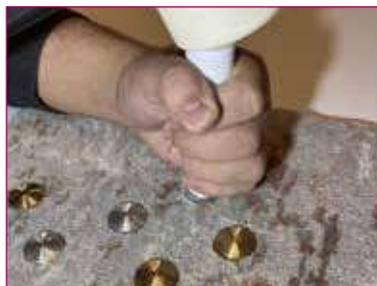
4 - Frapper celle-ci à l'aide d'un marteau pour riveter les 2 parties du clou.
