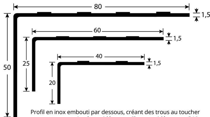
Profil en inox embouti par dessous, créant des trous au toucher rafeux, au pouvoir très antidérapant Classe antidérapante R12. A fixer avec vis inox  $\varnothing$  3,5 mm (non livrées).
