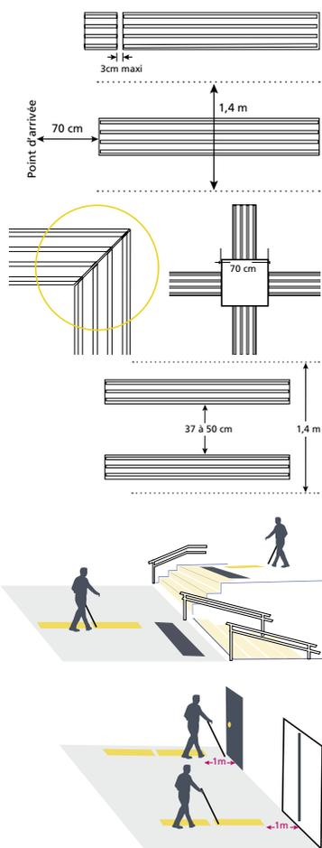
**Pour faciliter l'orientation, le cheminement doit être visuellement et tactilement contrasté (70% de différence entre le fond et le cheminement)**
