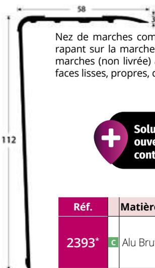
Nez de marches complet associant un antidérapant sur la marche et une bande de contremarches (non livrée) à coller. A percer sur surfaces lisses, propres, dépoussiérées.
