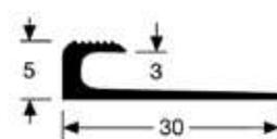
Pour assurer une bonne finition d'une LVT le long d'un mur, d'une baie vitrée, en jonction avec un revêtement de sol un peu plus épais ou comme simple arrêt de la LVT.
