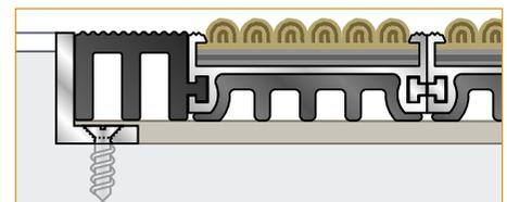
Bandes de finition en PVC rigide (à recouper) fournies en extrémité de tapis et servant à l'ajuster dans la fosse.
