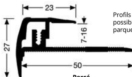
Profils striés antidérapants percés, avec possibilité de les ajuster suivant la hauteur du parquet ou du stratifié.
