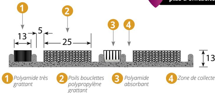
Le **QUICK TRIO** est un tapis de propreté révolutionnaire à usage commercial modéré à fréquent composé de polypropylène et de polyamide répartis sur **3 bandes** :
