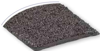
Profil plat antidérapant en polymère époxy avec inclusion de charges antidérapantes, de grande durabilité qui ne craint ni l'humidité, ni l'oxydation. Moulé galbé pour une épaisseur minimale aux extrémités afin d'éviter les surépaisseurs et sécuriser le passage.
