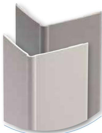
Cornière à angle variable avec liseré flexible qui lui permet de se conformer à tous les types d'angles rentrants ou sortants. En PVC lisse, antibactérien, classé Bs2 d0. Épaisseur 2 mm. Adhésif mousse
