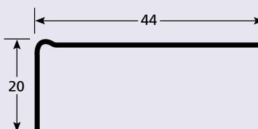
Pour réparer les nez de marche usagés, en bois ou béton. À clouer ou à visser, avant de refaire le ragréage par dessus. Tôle galvanisée.
