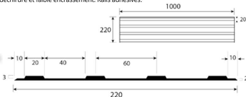
Pose en simple rail - 4 nervures
