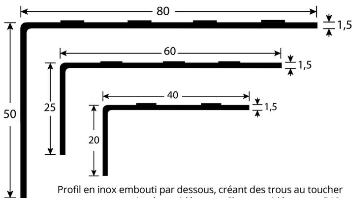
Profil en inox embouti par dessous, créant des trous au toucher rafeux, au pouvoir très antidérapant Classe antidérapante R12. A fixer avec vis inox  $\varnothing$  3,5 mm (non livrées).
