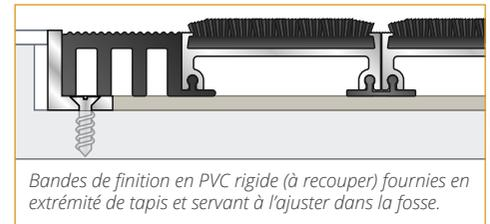
Bandes de finition en PVC rigide (à recouper) fournies en extrémité de tapis et servant à l'ajuster dans la fosse.
