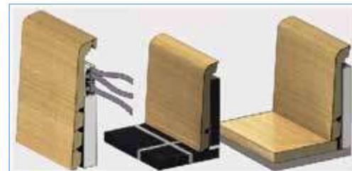
Créer un passage de câbles. Sur plinthes carrelage. Sur plinthes bois.
