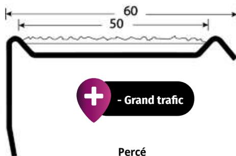
Pour installations ouvertes au public, gares, stades, habitats collectifs. Nez de marche inox ep. 1,2 mm avec insert de 4 mm d'épaisseur de résine coulée de méthacrylate et de granulats de marbre. Grande résistance mécanique et à la corrosion. Percé tous les 20 cm à fixer avec vis inox diam 3.5mm, non livrées. Coefficient de glissance SRT : sec 1.1, humide 0,74.
