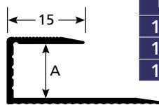
Pour une parfaite finition du parquet ou stratifié le long d'un mur, baie vitrée ou en jonction avec un carrelage.
