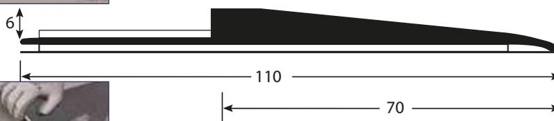
Adaptée au passage des transpalettes manuels et aux chariots élévateurs sur dalles GTI Max ou Attraction notamment. Adhésivée dessus, pour coller le revêtement et dessous, pour la coller sur le support si on ne peut pas percer (ex : sols amiantés). A souder au revêtement de sol pour une solution parfaitement étanche.
