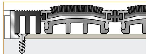
Bandes de finition en PVC rigide (à recouper) fournies en extrémité de tapis et servant à l'ajuster dans la fosse.
